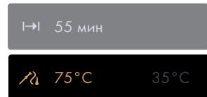
Если готовое блюдо остается в камере после выключения прибора, то воздействие остаточного тепла может привести к повышению температуры сердцевины.
